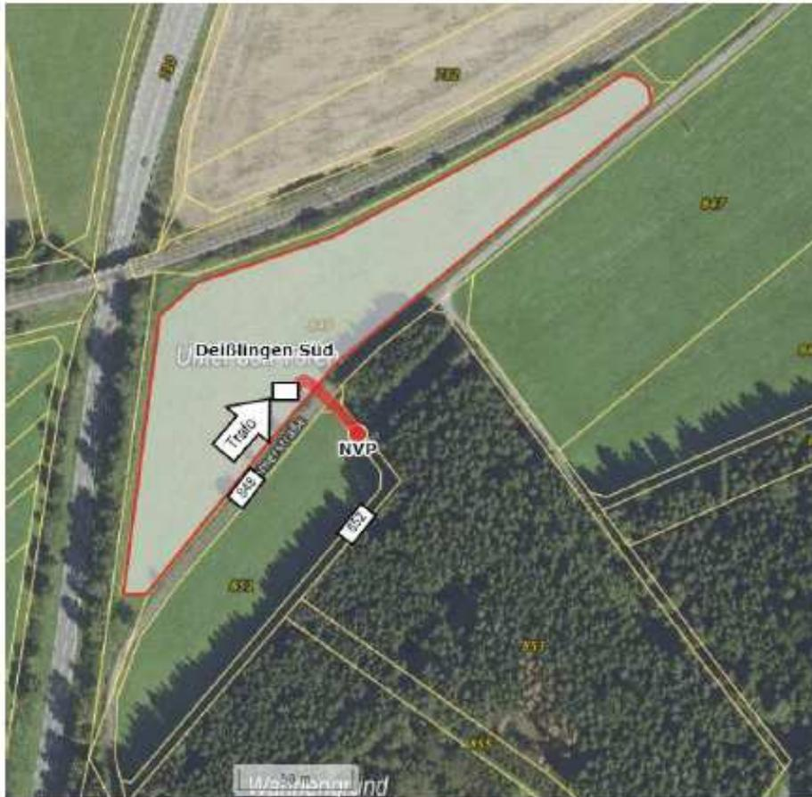
Kabelverlegung (in Rot auf dem Bild) in Flurstücken 848 und 852: Kabellänge ca. 35 m
