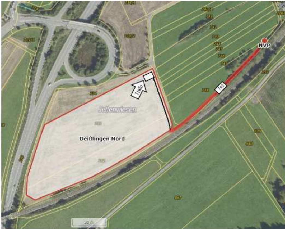
Kabelverlegung (in Rot auf dem Bild) in Flurstück 749: Kabellänge in Flurstück 749 ca. 200 m
